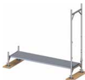
Figure 16: Enficher un cadre d'échafaudage.
