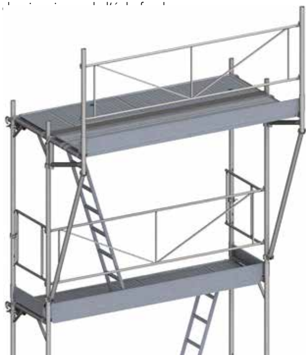
Figure 39 : Échafaudage avec consoles de 0,70 m.
