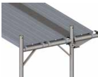
Figure 38 : Échafaudage avec consoles de 0,30 m.
