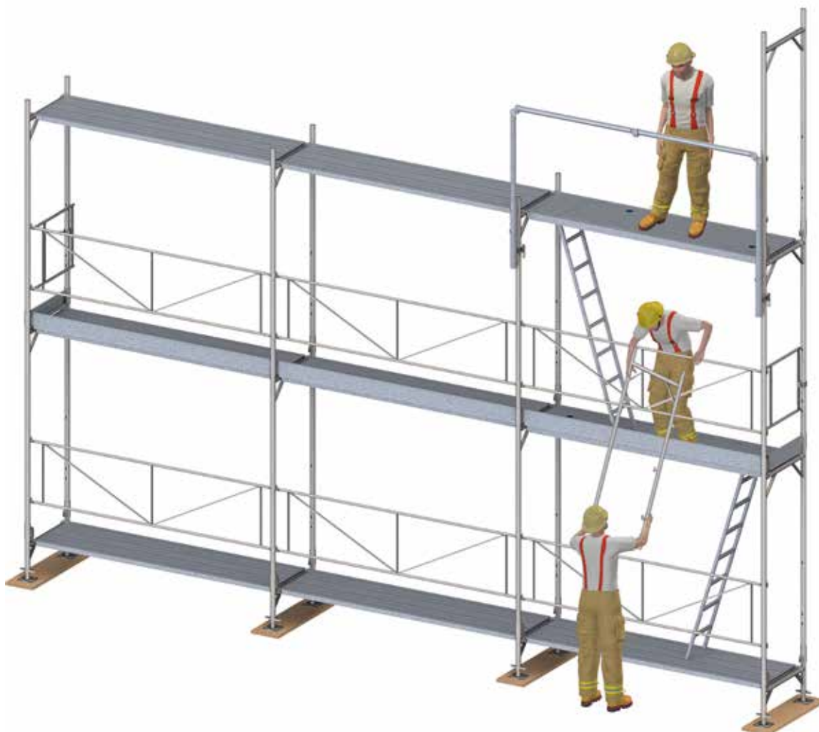
Figure 13: Exemple de réception de matériau et de montage sur le niveau supérieur de l'échafaudage.
