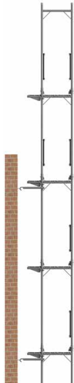
Figure 43 : Niveau d'échafaudage autoporteur lors des étapes intermédiaires de construction de bâtiments.
