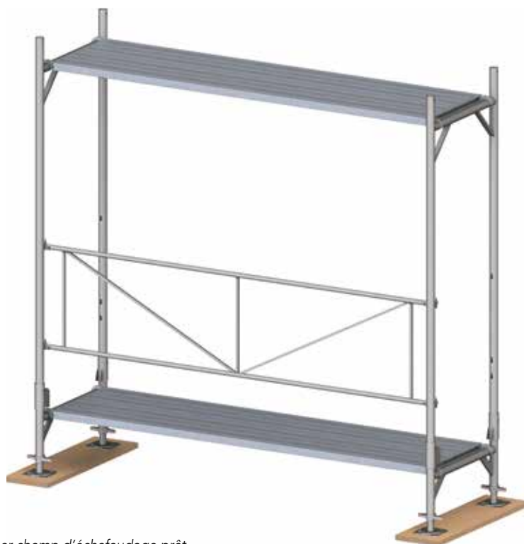
Figure 8: Premier champ d'échafaudage prêt.
